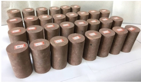
图 1 加工后的红砂岩试样
