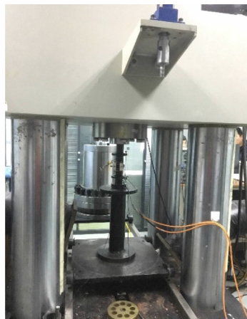
图 3 2 000 kN 三轴试验机
