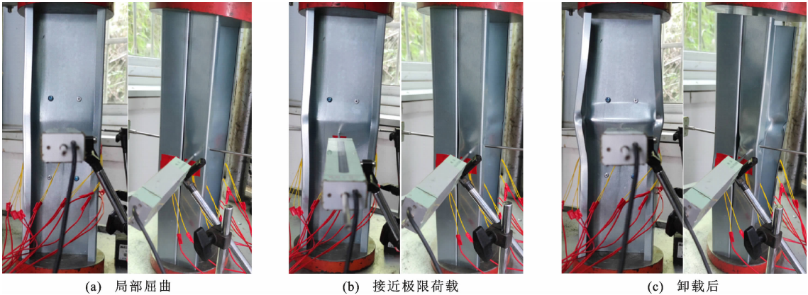
图 11 SC150-B 破坏过程 Fig. 11 Failure process of SC150-B
